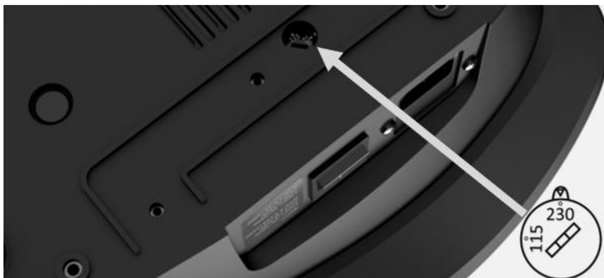
Rysunek 6.1. Selektor napięcia
