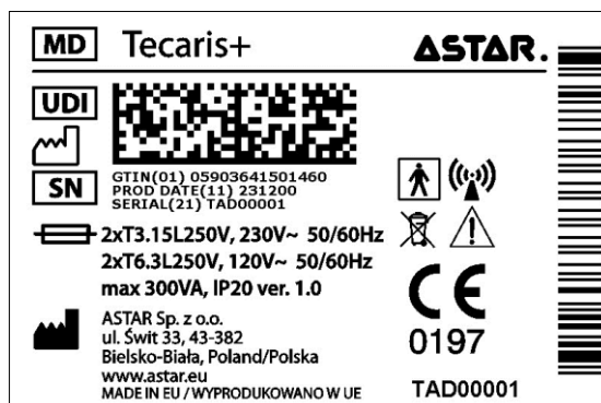
Rysunek 5.4. Tabliczka znamionowa aparatu Tecaris+
